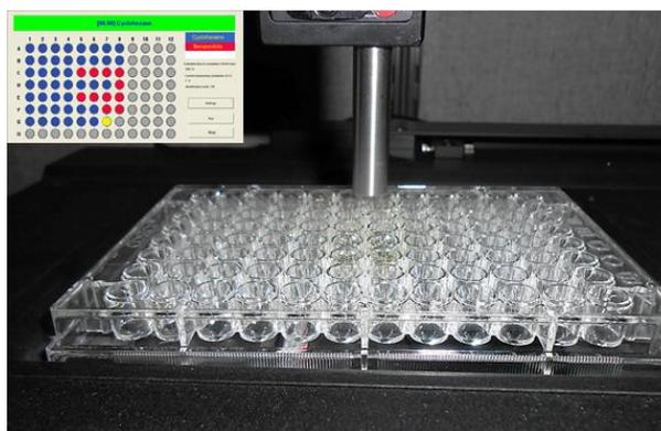
图5: 用于自动拉曼采集的96孔微孔板取样附件；插图：开启识别模式进行自动测量时的软件界面
