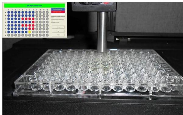
图6 (上图): 用于自动拉曼采集的96孔微孔板取样附件
