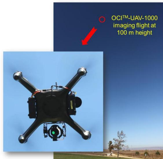
图 1. BaySpec 的 OCI 高光谱成像仪超小型、重量轻(总重量为 0.3 kg)，专为在小型无人机上使用而设计。图中所示为执行空中高光谱成像任务的系统。
